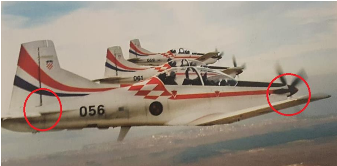
Slika 3.2. Vizura za pozicioniranje pratitelja u primaknutom postroju
