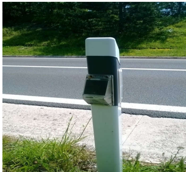
Slika 41. Zvučni senzor na smjerokaznom stupiću
