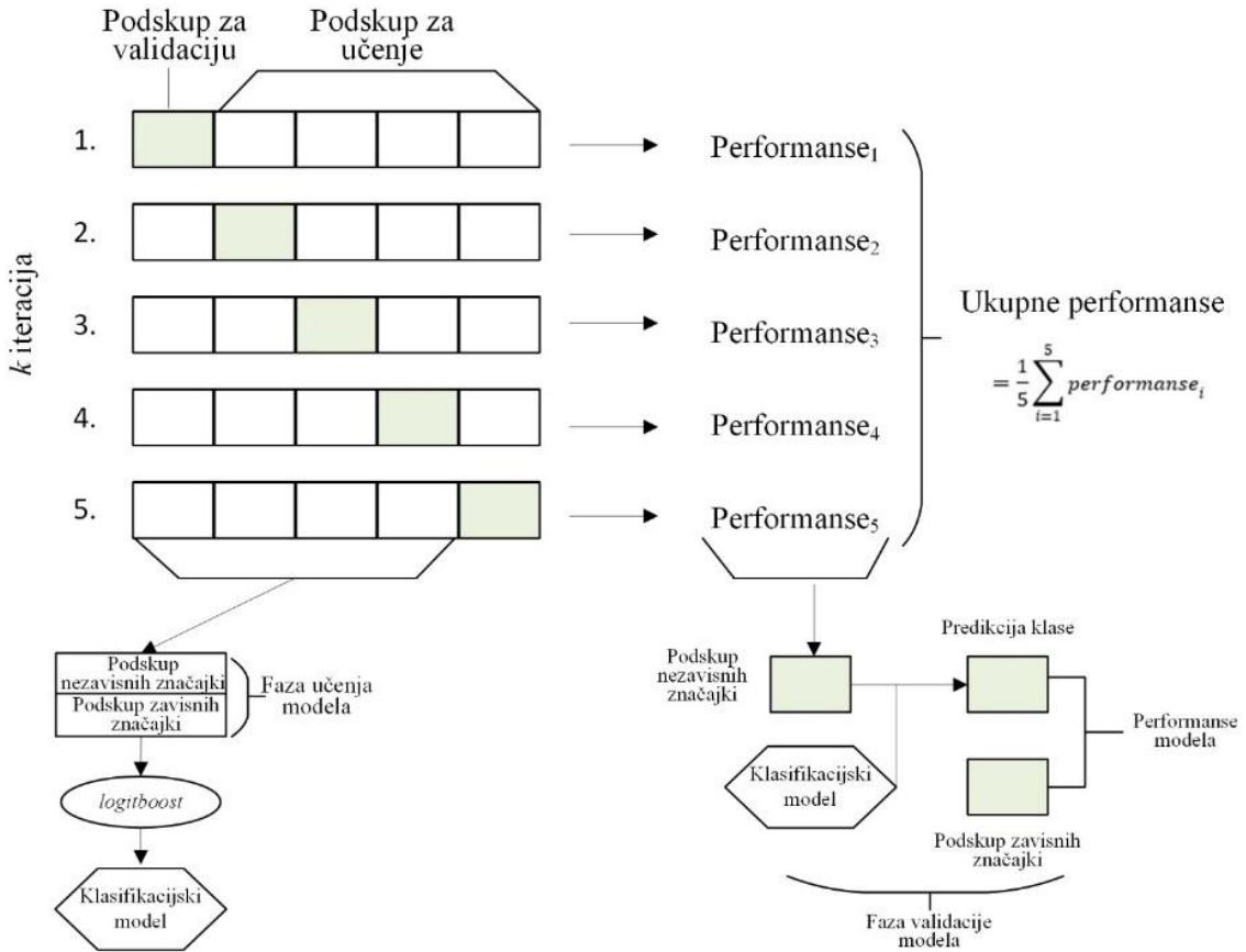
Slika 5.8 Prikaz  $k$ -strukture unakrsne validacije uz  $k=5$  [222]
