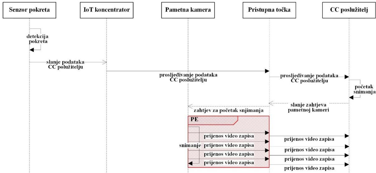
Slika 3.6 UML dijagram međudjelovanja komunikacijskog procesa u kojem se generira PE uzorak prometa
