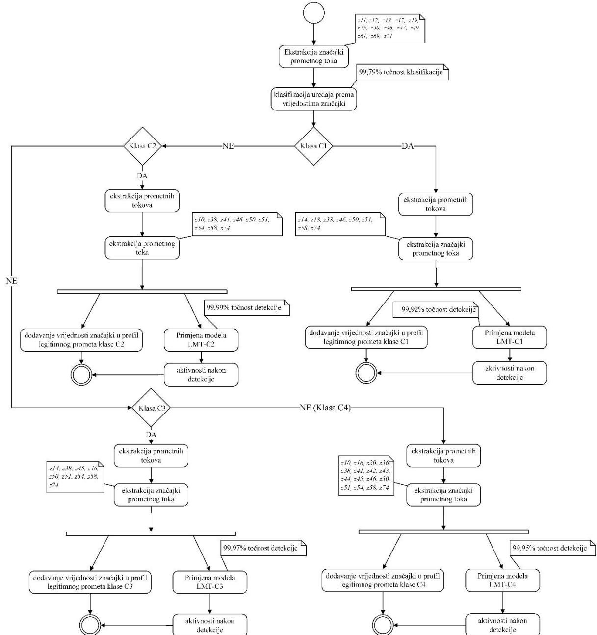
Slika 5.13 Princip rada razvijenog modela detekcije nelegitimmog DDoS prometa za pojedinačni SHIoT uređaj
