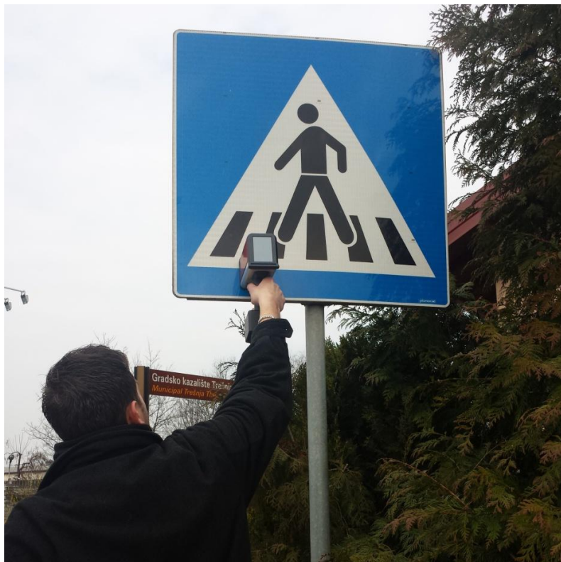
Slika 25. Ispitivanje retrorefleksije prometnog znaka pomoću uređaja Zehntner ZRS 6060
