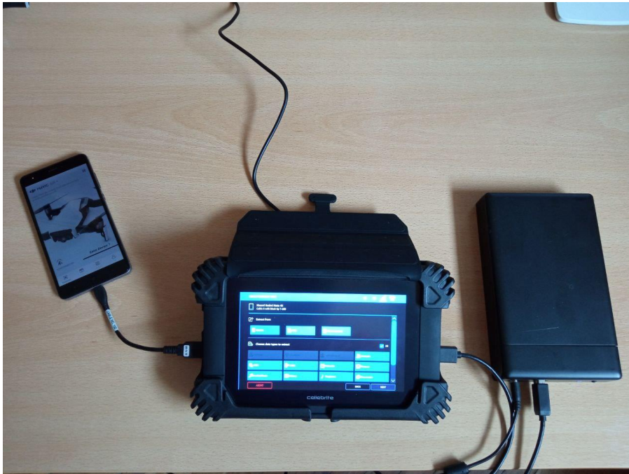
Slika 14. Ekstrakcija podataka mobilnog uređaja pomoću uređaja UFED Touch 2
