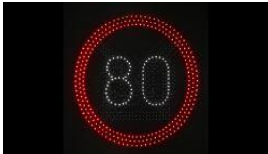
Slika 4. VMS elektronički prometni znakovi[14]
