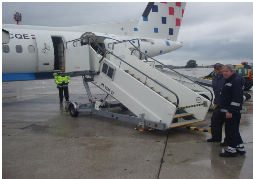
Slika 3. Proces postavljanja putničkih stepenica na avion, [3]
