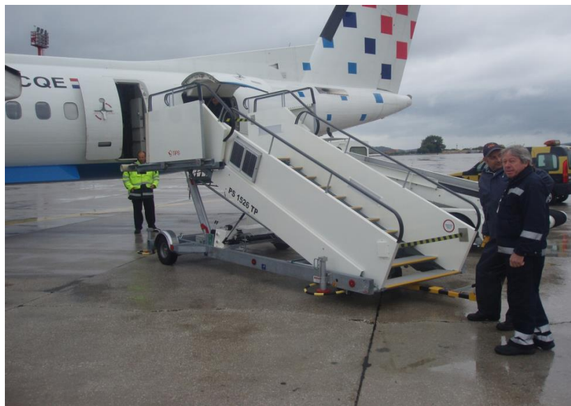
Slika 3. Proces postavljanja putničkih stepenica na avion, [3]
