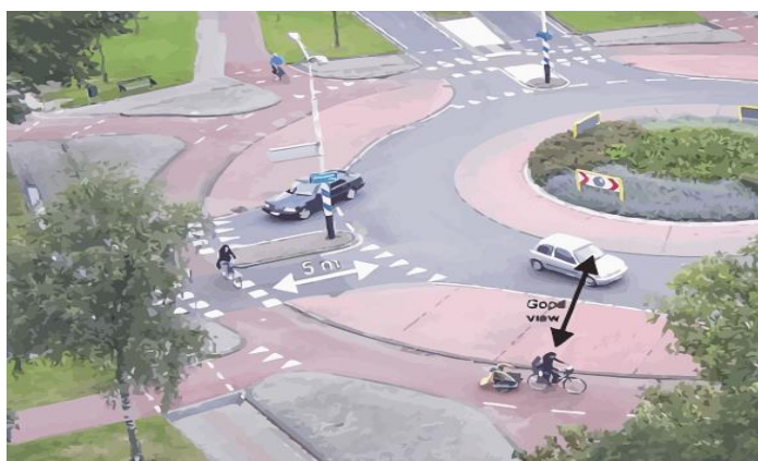
Slika 7. Primjer kružnog raskrižja sa prijelazima za pješake i bicikliste
