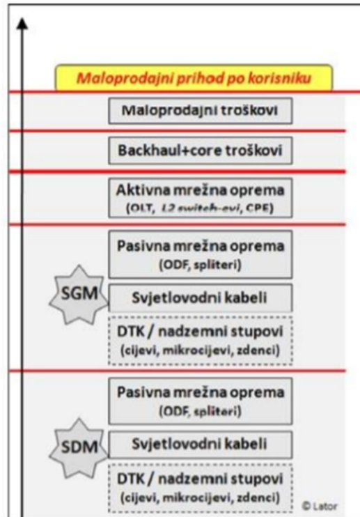
Slika 12. Struktura jediničnih troškova za FTTH operatora u idealnom slučaju. (9)
