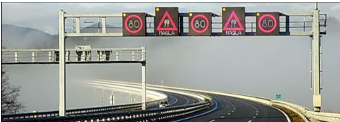
Slika 6. Primjer promjenjive prometne signalizacije na autocesti, [40]
