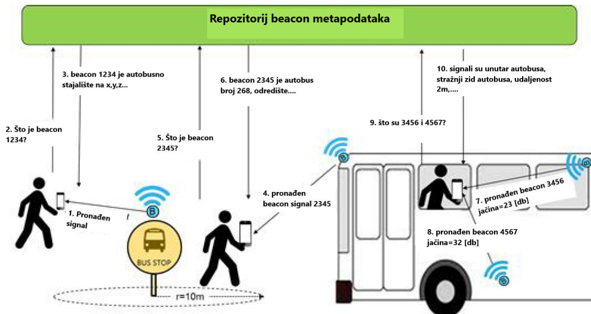
Slika 30. Korištenje Bluetooth beacona u javnom gradskom prijevozu, [41]
