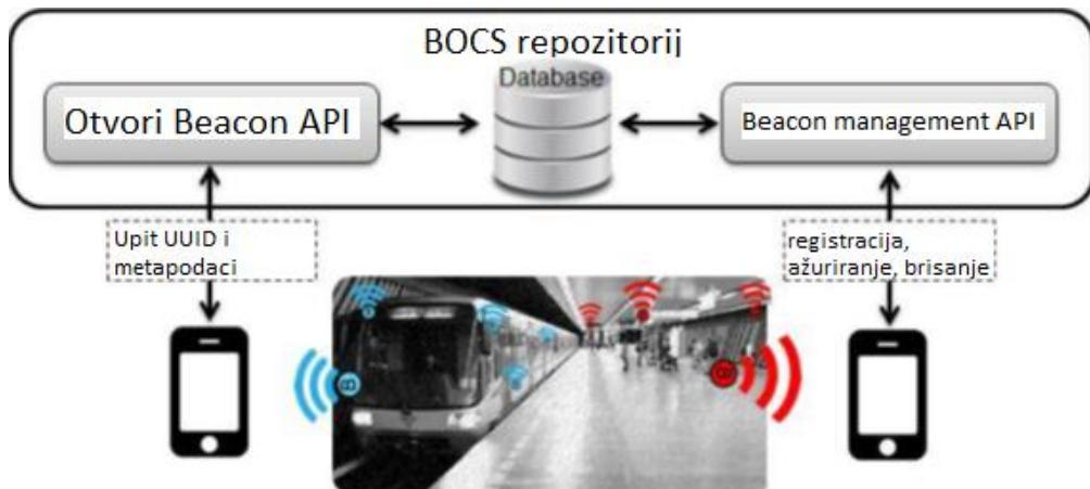
Slika 32. Prikaz visoke razine arhitekture BOCS sustava, [41]
