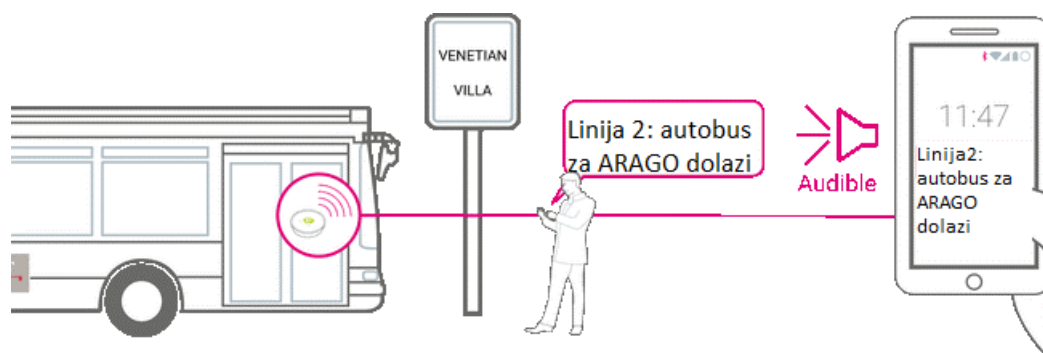
Slika 26. Prikaz razmijene informacija pomoću bluetooth tehnologije između korisnika i pružatelja usluge na primjeru javnog gradskog autobusnog prijevoza, [37]
