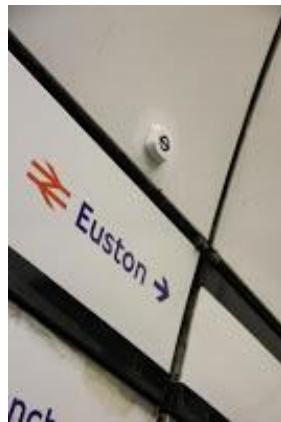
Slika 27. *Beacon* odašiljač u podzemnoj željezničici, [39]
