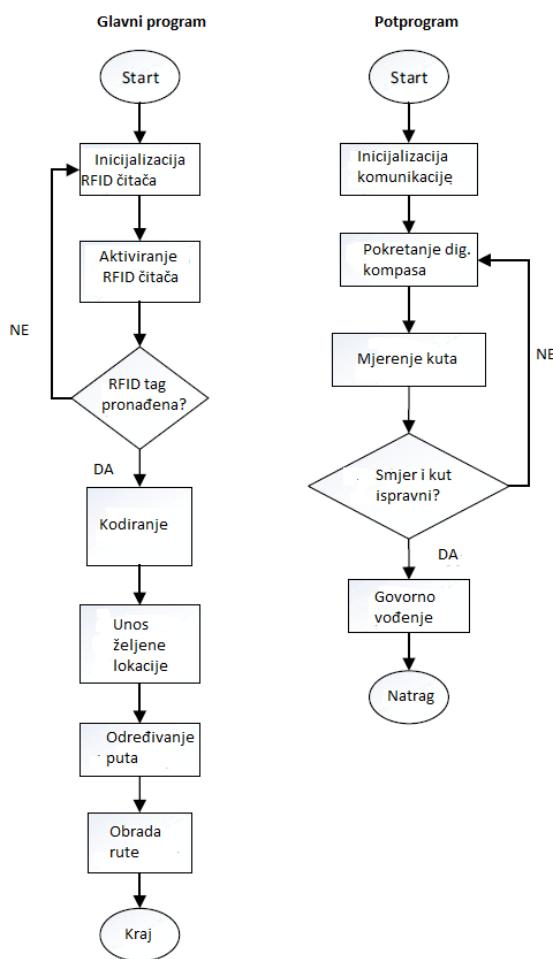
Slika 20. Dijagram toka RFID navigacijskog sustava, [34]
