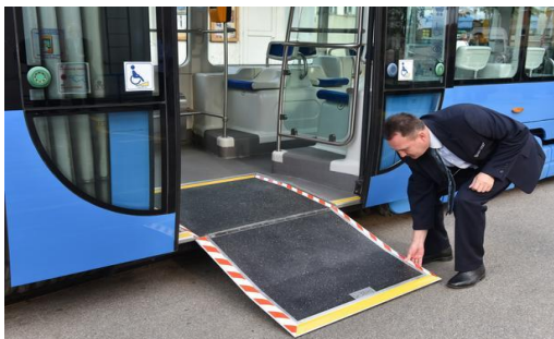
Slika 1. Izgled ulaza u javni gradski autobus za osobe u invalidskim kolicima, [6]
