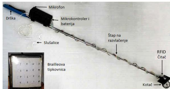
Slika 19. Prikaz elektroničkog štapa i njegovih komponenti, [34]
