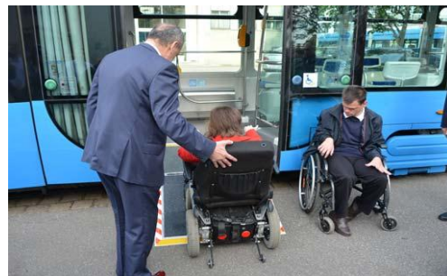
Slika 2. Način ulaska u javni gradski autobus za osobe u invalidskim kolicima, [7]
