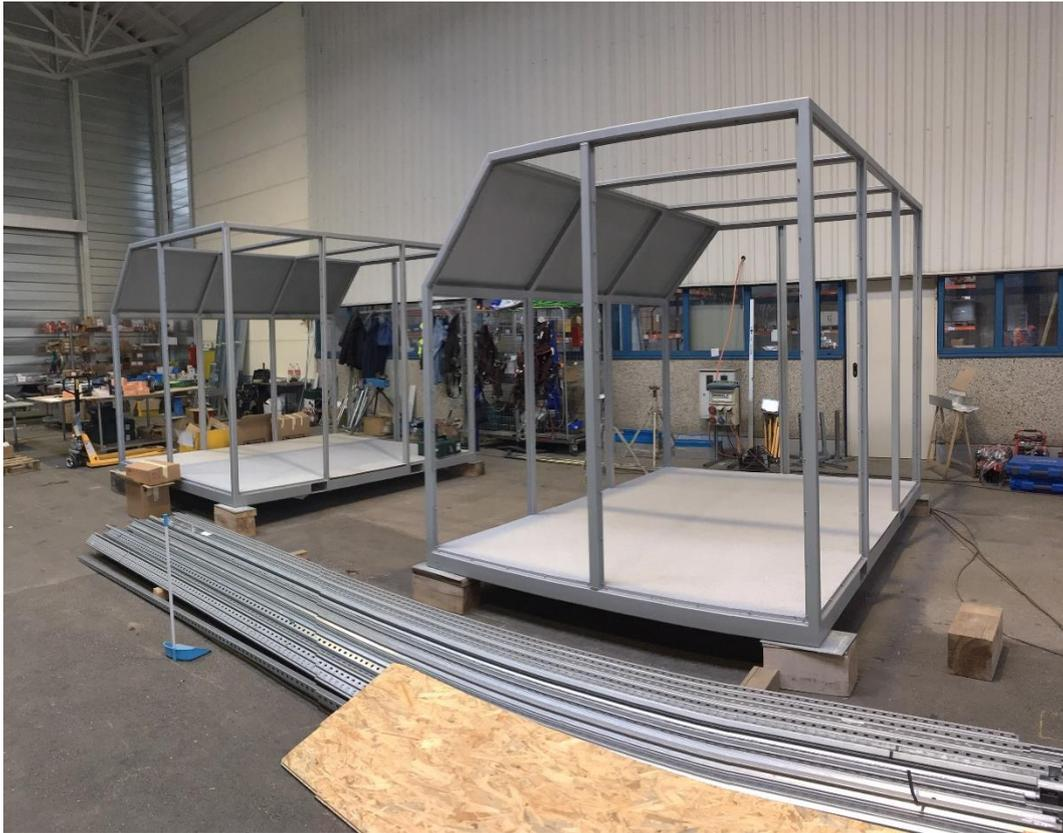
**Slika 8.** Konstrukcija okvira AMJ kontejnera, [20]
