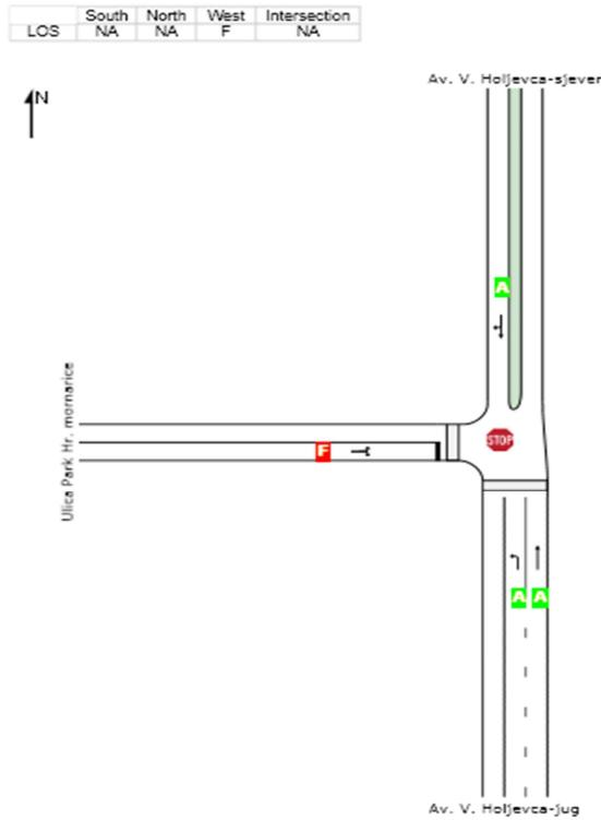
Slika 7. Analiza prometnih tokova uporabom simulacijskog alata SIDRA
