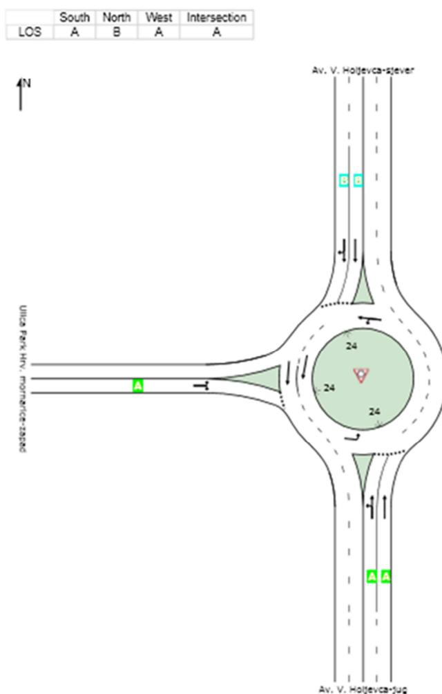
**Slika 18.** Prikaz idejnog rješenja raskrižja pomoću simulacijskog alata „Sidra Intersection“, (varijanta 2)
