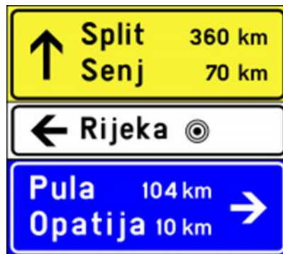
Slika 7. Putokazna ploča (D07)
