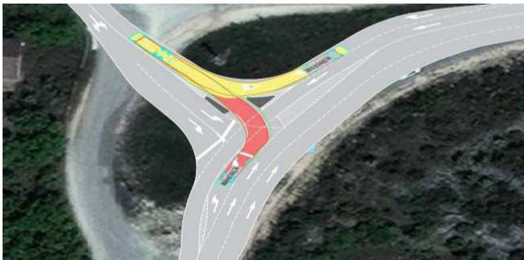
Slika 52. Trajektorija provoženja mjerodavnog vozila sa glavnog na sporedni privoz – Raskrižje 1
