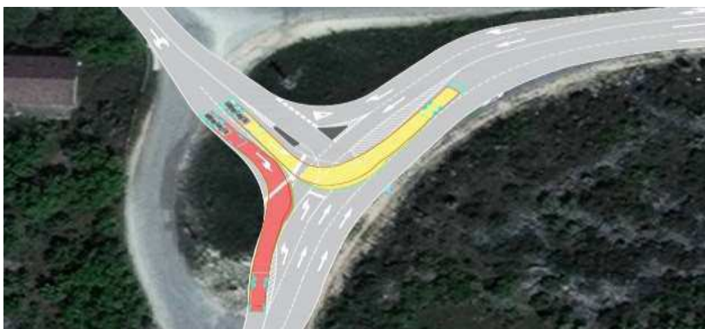
Slika 53. Trajektorija provoženja mjerodavnog vozila sa sporednog na glavni privoz – Raskrižje 1
