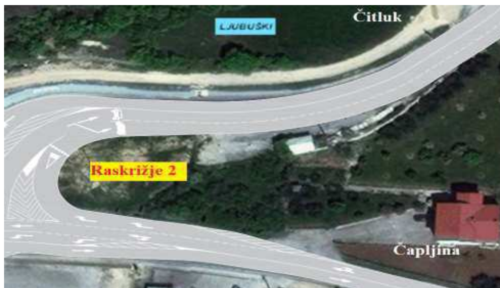
Slika 45. Idejno rješenje traka za spora vozila – početak traka (Raskrižje 2)
