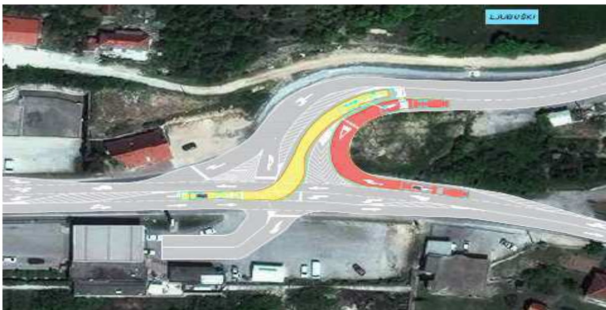
Slika 55. Trajektorija provoženja mjerodavnog vozila sa glavnog na sporedni privoz – Raskrižje 2
