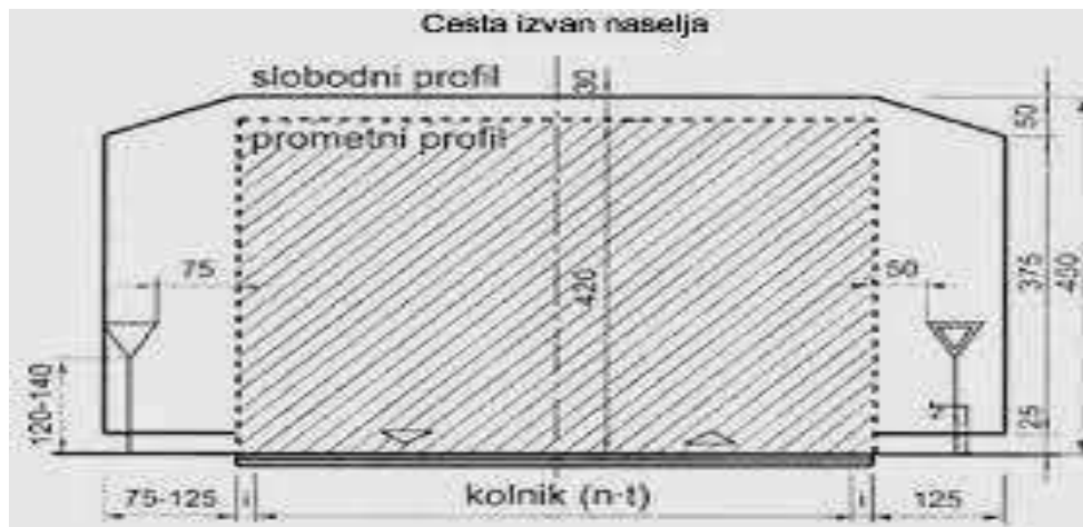
Slika 26. Prometni i slobodni profil ceste izvan naselja
