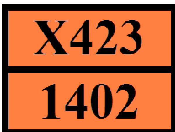
Slika 19. Primjer ploče opasnosti za kalcijev karbid
