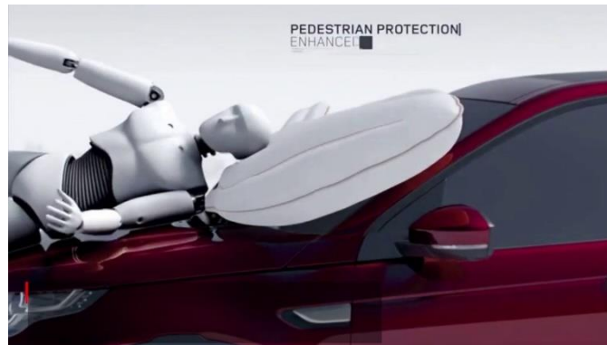
Slika 58. Princip rada zračnog jastuka za pješaka
