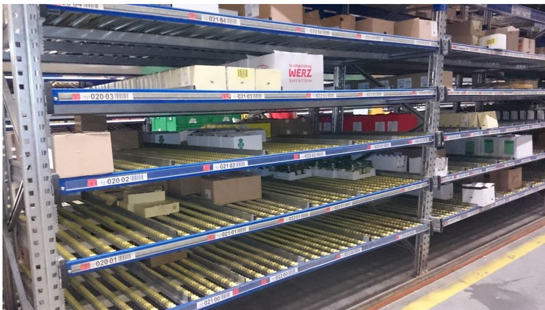
Slika 2.9. Stražnja strana gravitacijske protočne police (strana s koje se polica nadopunjava)
