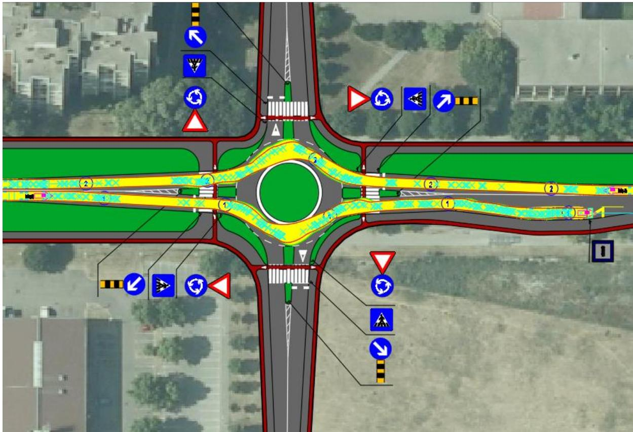
**Slika 31.** Prikaz trajektorije mjerodavnog vozila na raskrižju 1
