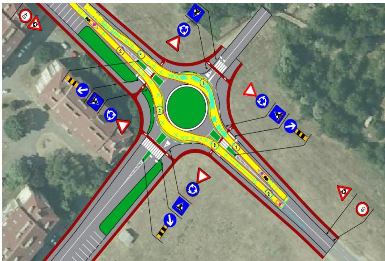
**Slika 33.** Prikaz trajektorija mjerodavnog vozila na raskrižju 2
