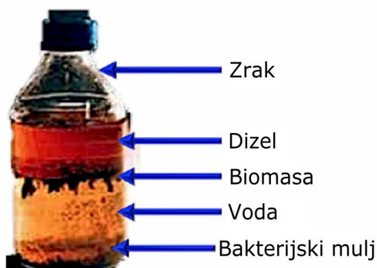
Slika 72. Degradacija tekuće tekuće biomase
