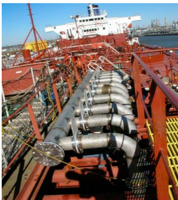
Slika 63. Cjevovod za transport tekuće rasute biomase
