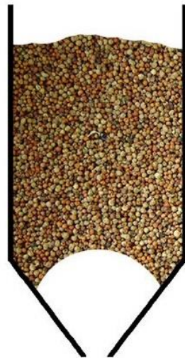
Slika 74. Problem zasvođavanja biomase unutar lijevka
