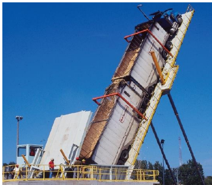
Slika 27. Iskrcaj biomase naginjanjem kamiona
