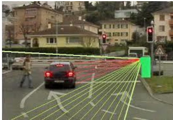
Slika 15. Lasersko osvjetljenje željezničko-cestovnog prijelaza [22]
