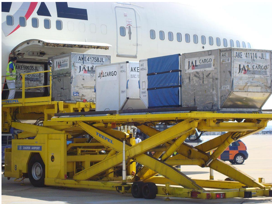
Slika 1. Istovar ULD kontejnera iz zrakoplova, [3]
