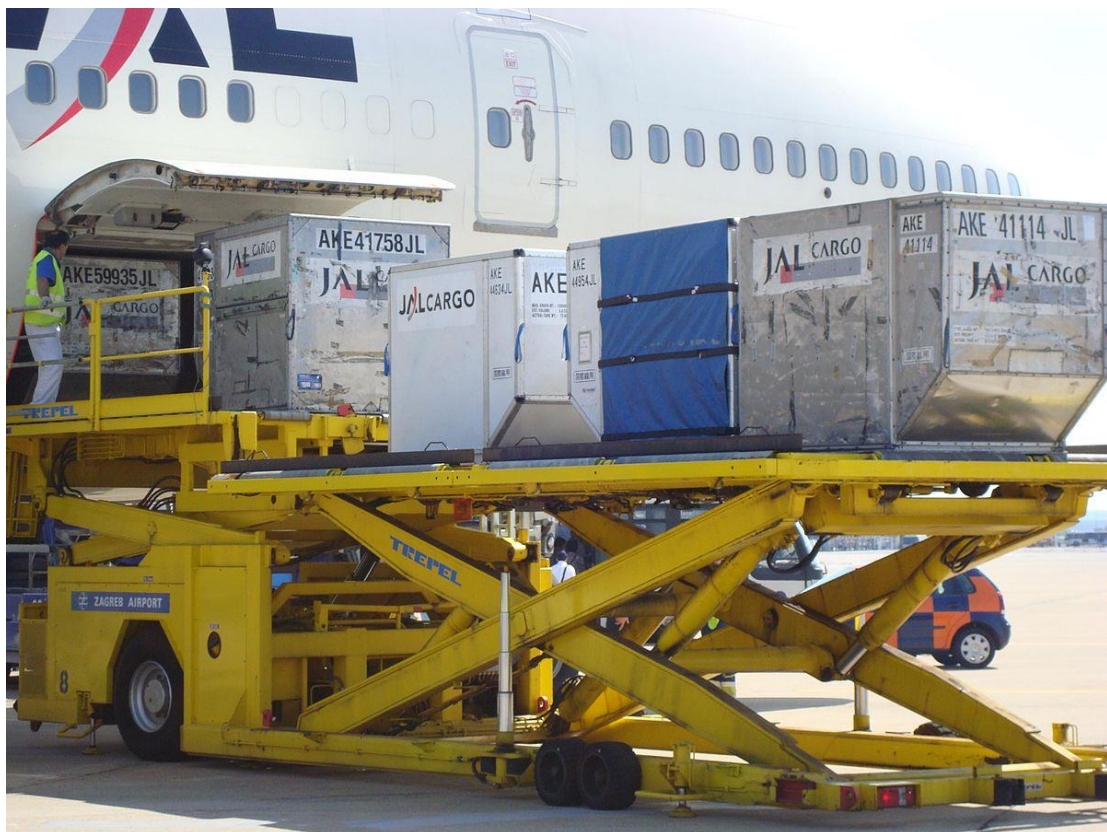
Slika 1. Istovar ULD kontejnera iz zrakoplova, [3]
