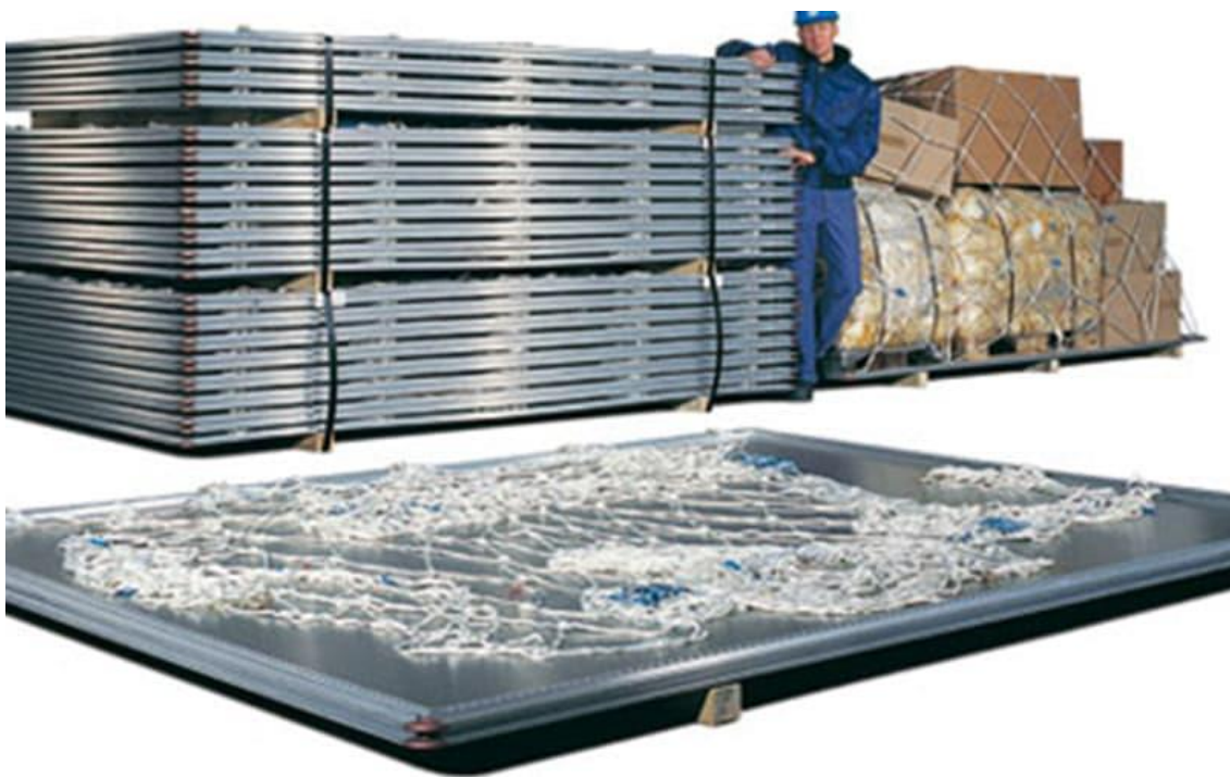
Slika 8. Izgled ULD zrakoplovnih paleta, [11]
