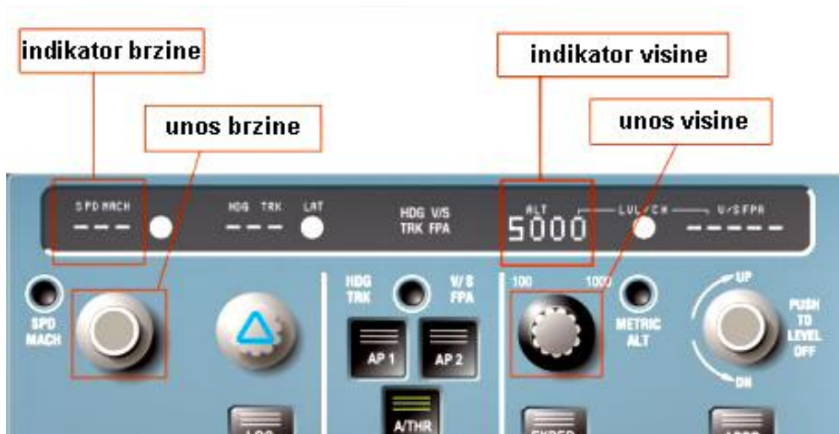
Slika 9. Unos parametara u autopilot Airbus A320, [14]
