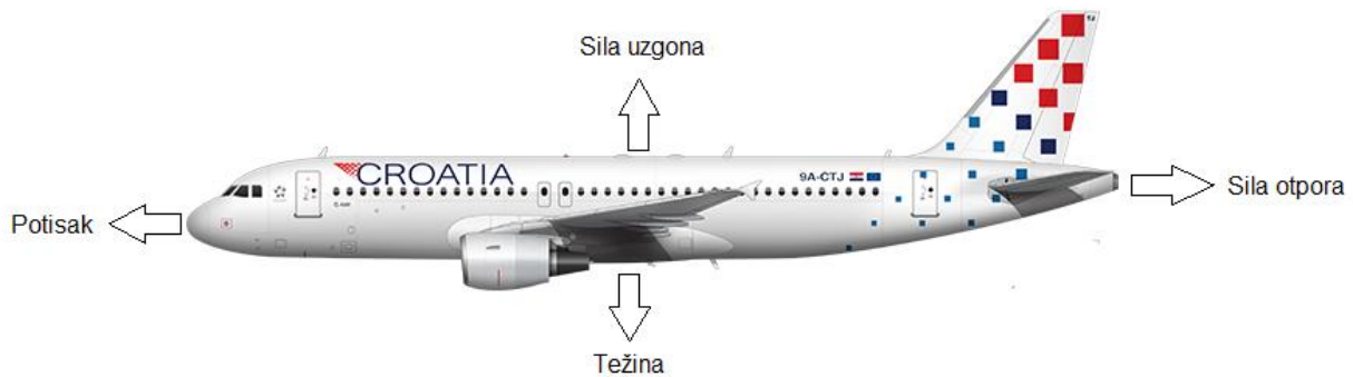
Slika 2: Sile koje djeluju na zrakoplov u ustaljenom horizontalnom letu
