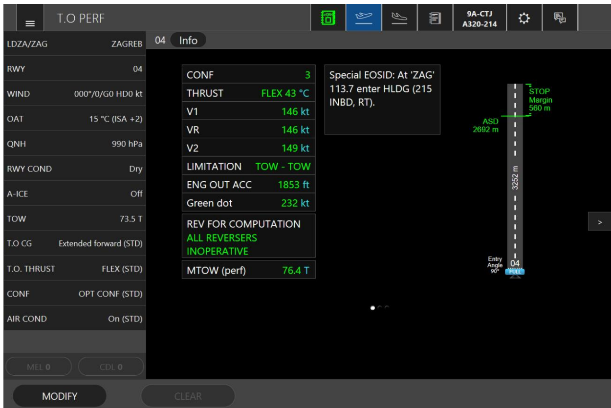
Slika 24: FlySmart sučelje s proračunima za polijetanje sa Međunarodne zračne luke Zagreb uz uvjet QNH 990 hPa
