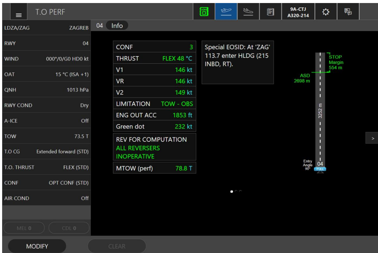
Slika 25: FlySmart sučelje s proračunima za polijetanje sa Međunarodne zračne luke Zagreb uz uvjet AIR COND = off
