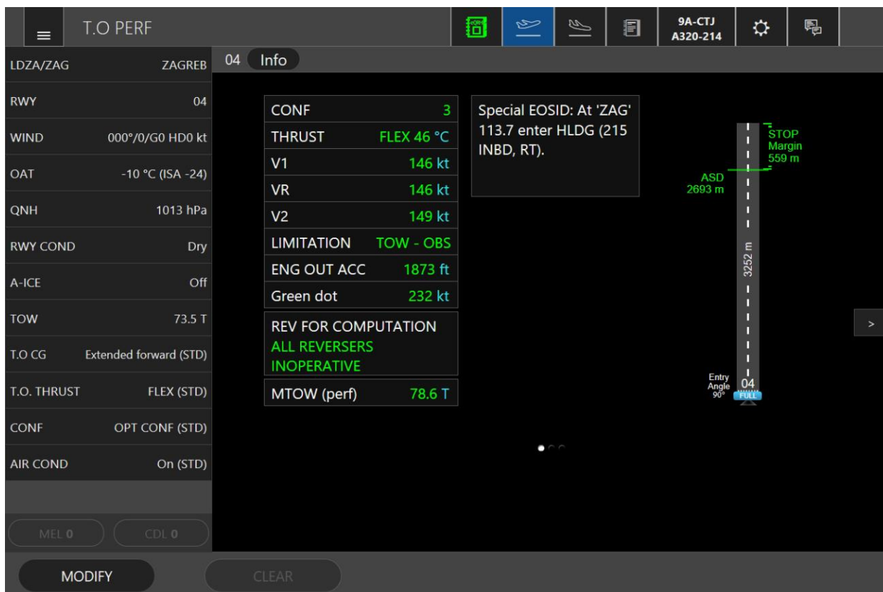
Slika 22: FlySmart sučelje s proračunima za polijetanje sa Međunarodne zračne luke Zagreb uz uvjet OAT -10 °C
