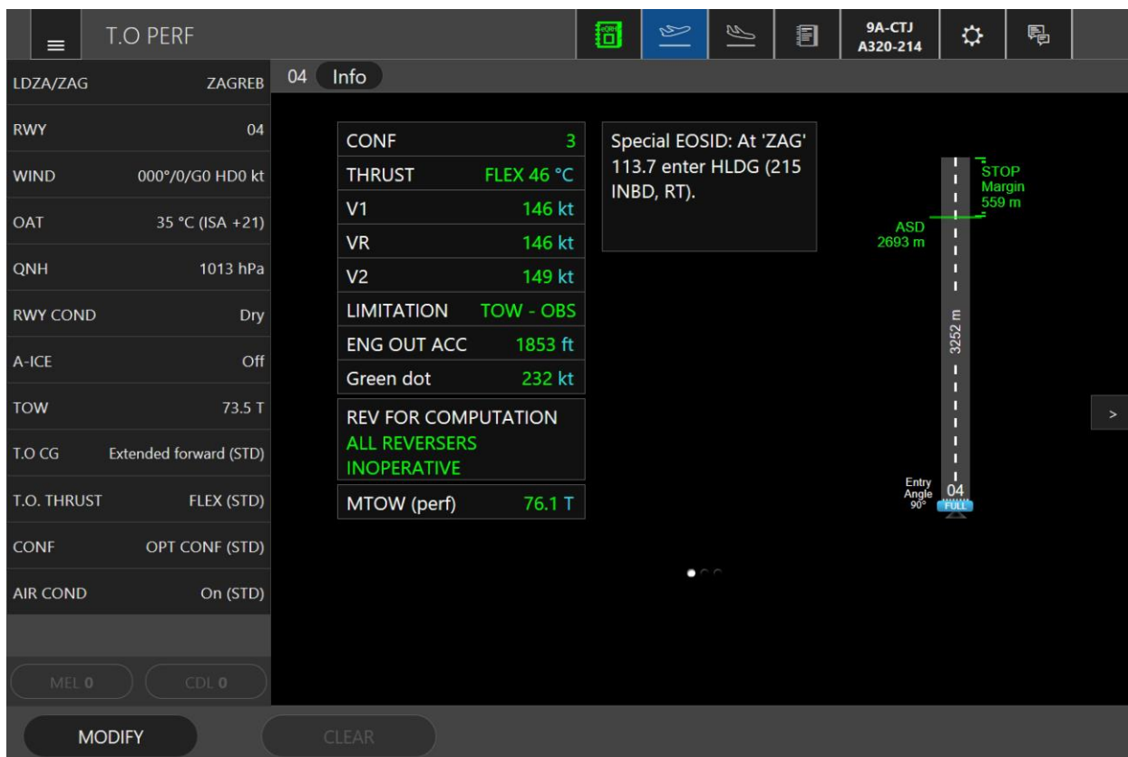
Slika 21: FlySmart sučelje s proračunima za polijetanje sa Međunarodne zračne luke Zagreb uz uvjet OAT 35 °C
