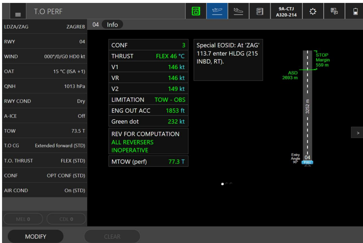
Slika 18: FlySmart sučelje s proračunima za polijetanje sa Međunarodne zračne luke Zagreb na temelju ISA uvjeta
