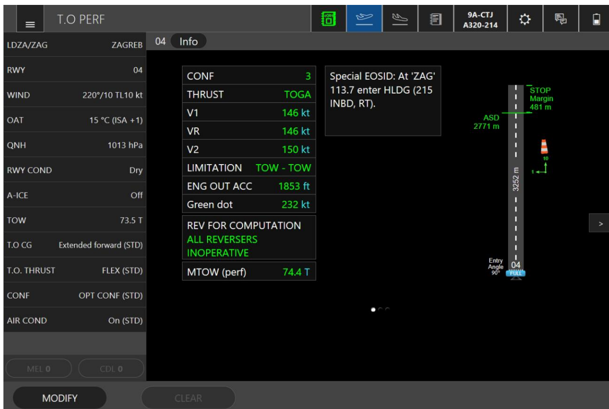
Slika 19: FlySmart sučelje s proračunima za polijetanje sa Međunarodne zračne luke Zagreb na temelju uvjeta s repnim vjetrom
