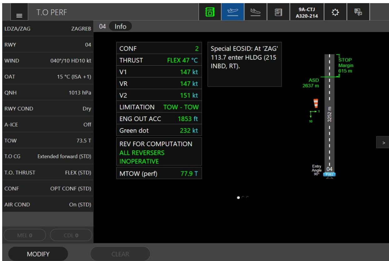
Slika 20: FlySmart sučelje s proračunima za polijetanje sa Međunarodne zračne luke Zagreb na temelju uvjeta s leđnim vjetrom
