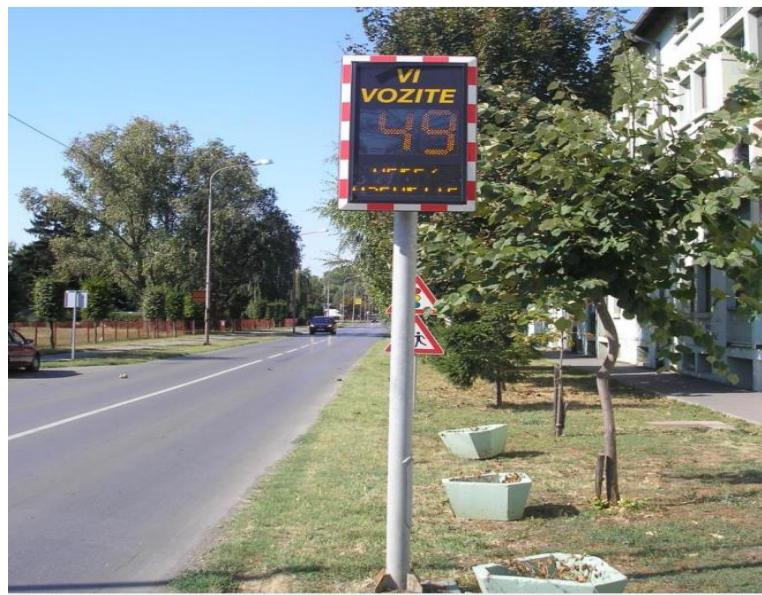
Slika 25: Smirivanje prometa uređajem za određivanje brzine vožnje
