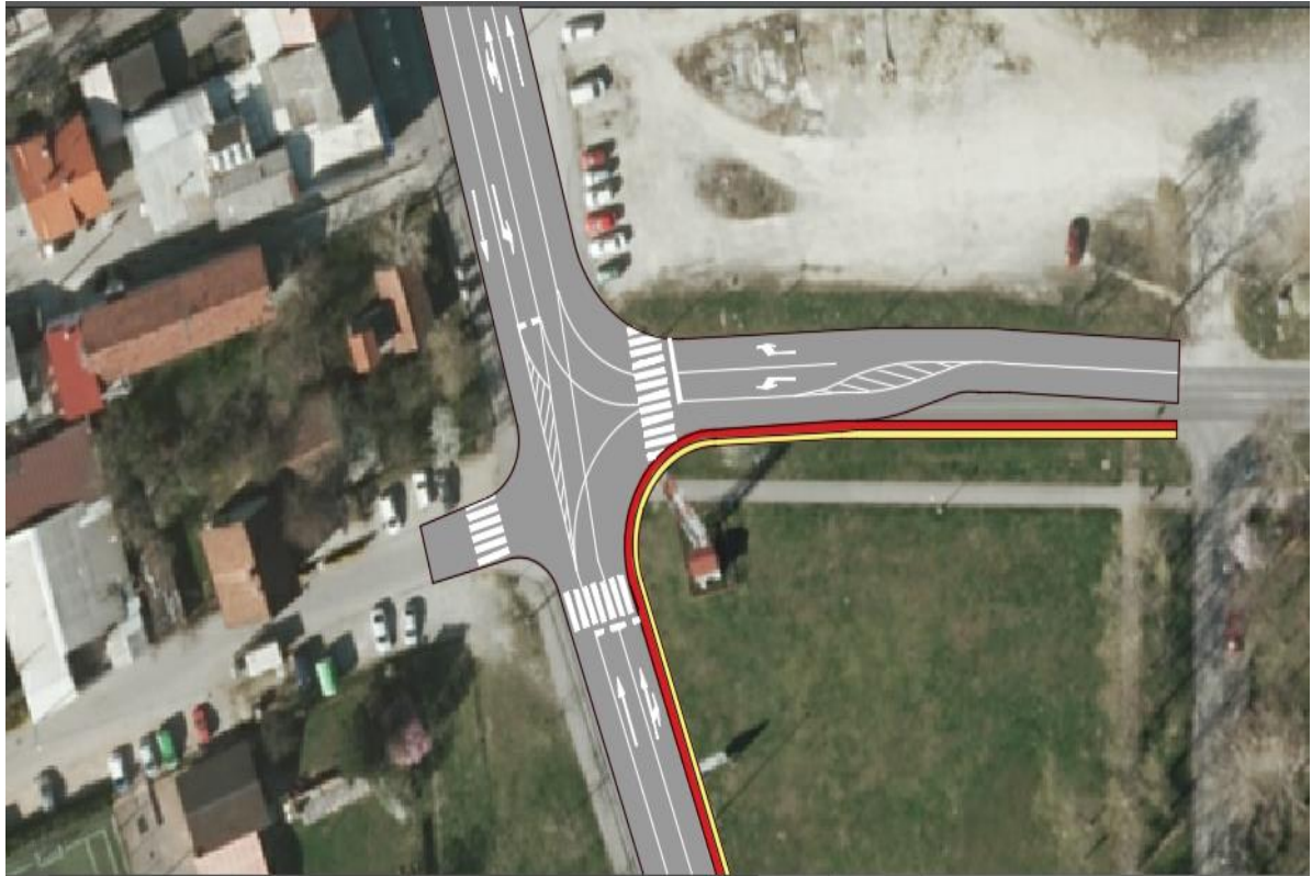
Slika 39 : Prijedlog optimalnog rješenja raskrižja
