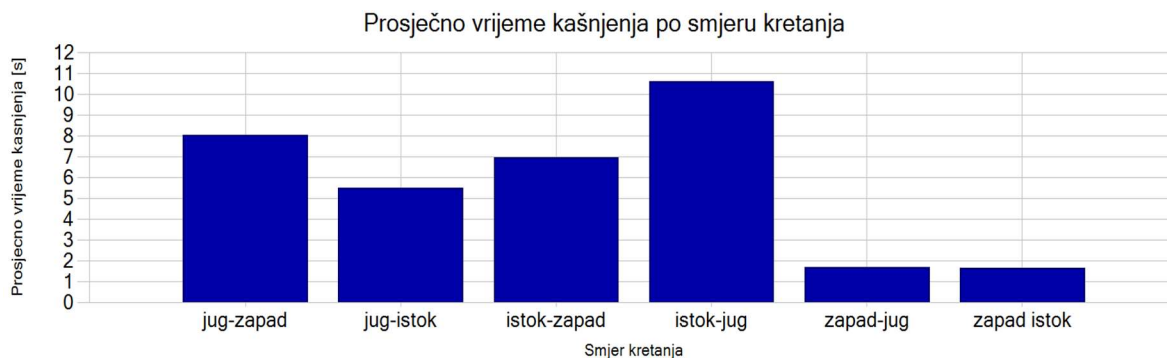
Slika 29. Prikaz grafikona iz simulacijskog alata PTV Vissim za prosječno vrijeme kašnjenja trećeg raskrižja
