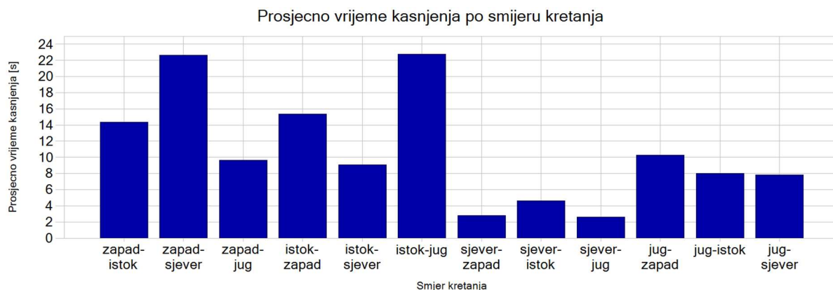
Slika 23. Prikaz grafikona iz simulacijskog alata PTV Vissim za prosječno vrijeme kašnjenja drugog raskrižja
