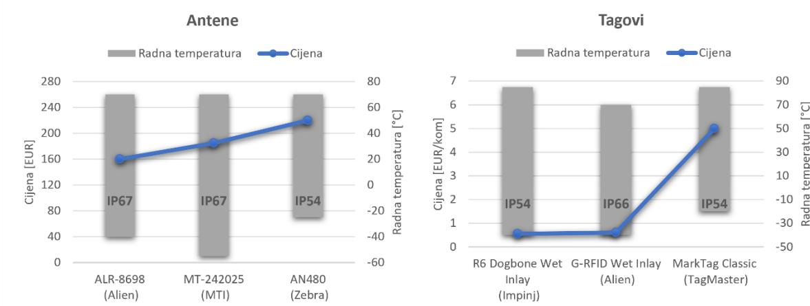
Slika 15. Omjer radne temperature i cijene antena (lijevo) i tagova (desno) (RFID)
