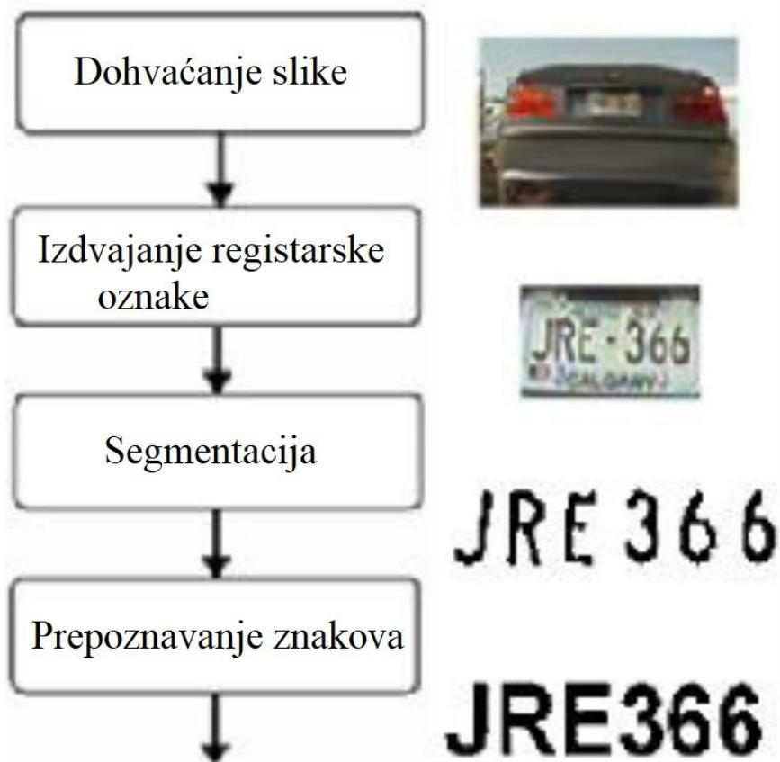
Slika 8. Princip rada ANPR sustava
