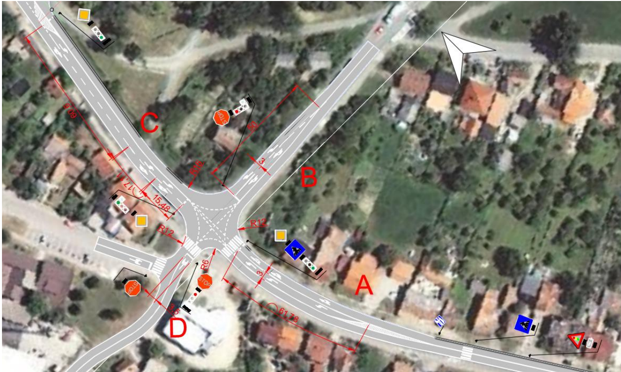
Slika 7 Skica raskrižja J. J. Strossmayera – Ulica Hrvatskih domobrana – Aleja narodnih heroja, AutoCAD
