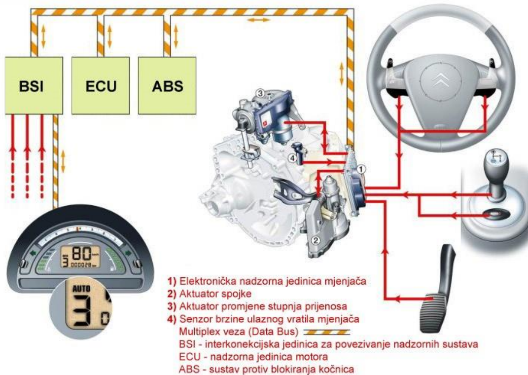
Slika 16. Upravljački i nadzorni sustav automatskog mjenjača [26]
