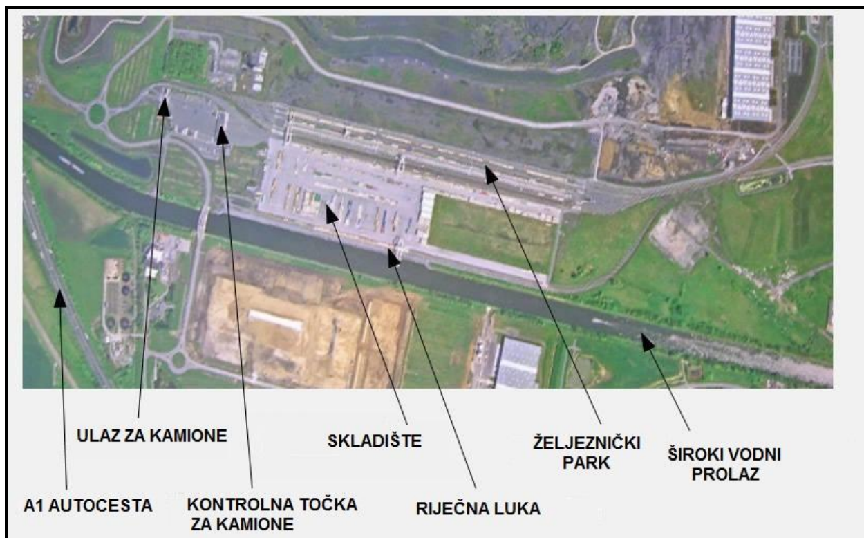
Slika 12. Detaljan prikaz rasporeda jedinica na terminalu LDCT
