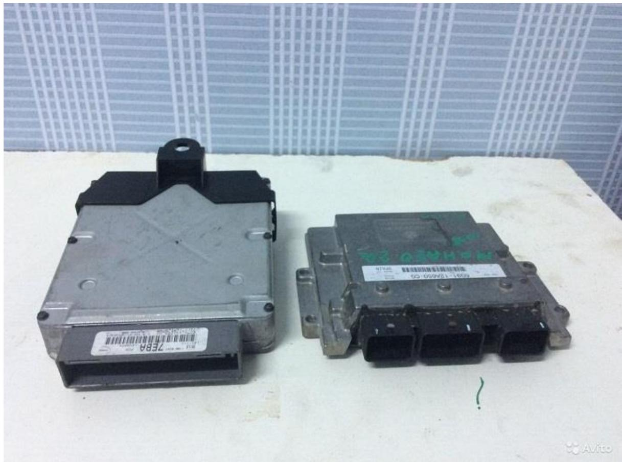
Slika 4. Centralna jedinica za upravljanje motora, [15]
