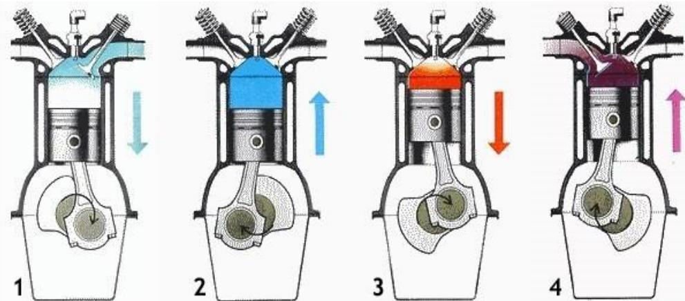
**Slika 1.** Četiri takta kod četverotaktnih motora, [2]
