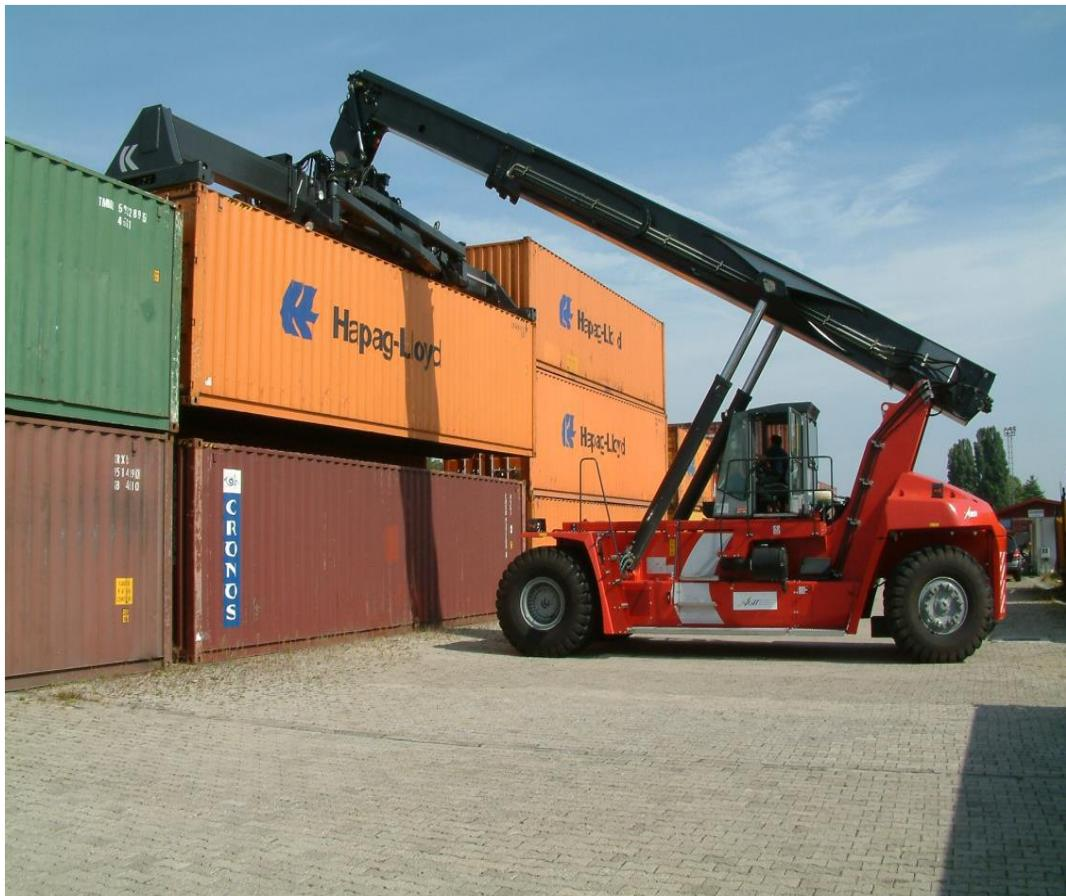
**Slika 10.** Prijenosni manipulator Kalmar tip Contchamp DRF 400 – C5
