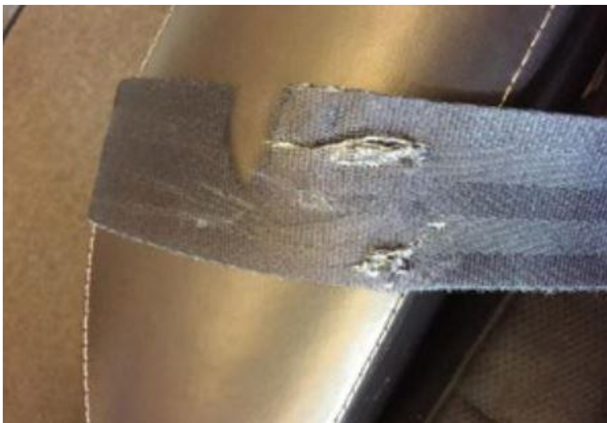
Slika 13. Oštećen sigurnosni pojas (Izvor: [8])
