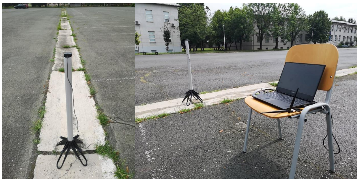
Slika 12. Prikaz RTK bazne stanice spojene na računalo
