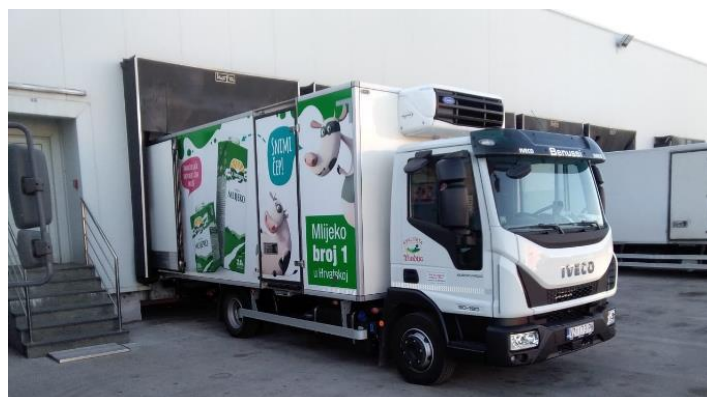
Slika 8 Kamion sa hladnjačom za prijevoz mlijeka i mliječnih proizvoda
