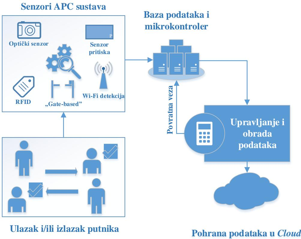
Slika 5: Pojednostavljeni prikaz funkcioniranja sustava automatskog brojanja putnika, [25]
