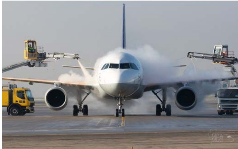
Slika 9. Odleđivanje zrakoplova A320-214 u Munchenu, [8]
