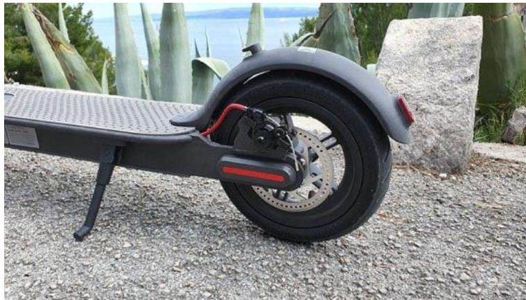
Slika 6. Disk kočnica električnog romobila
