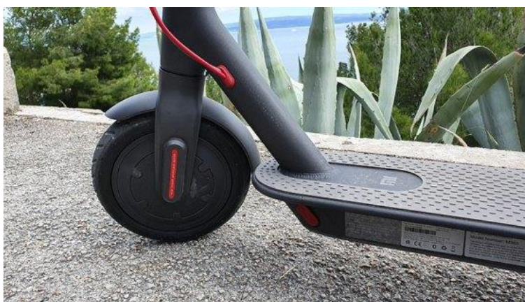
Slika 5. Motor električnog romobila smješten na prednjem kotaču
