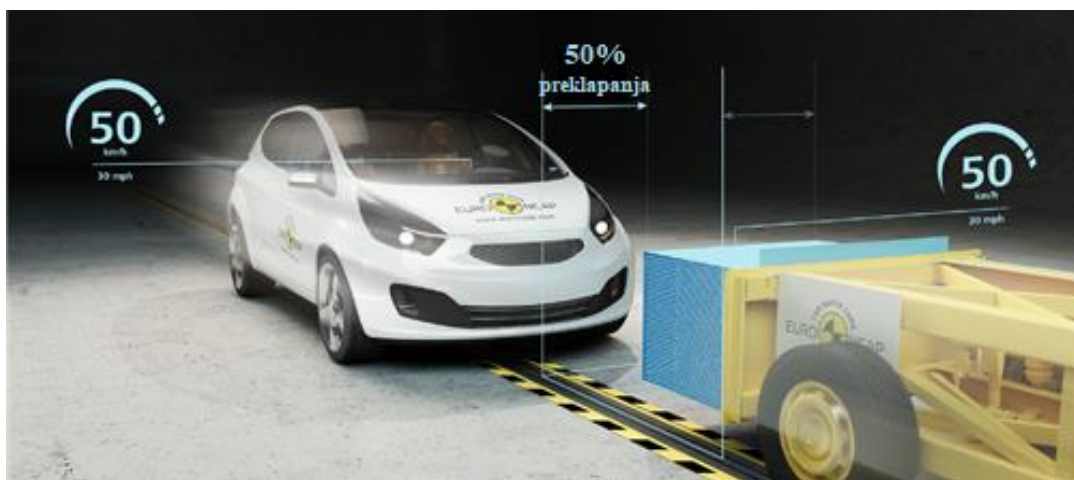
Slika 27: Frontalni sudar s 50% čeone površine prednjeg djela vozila
