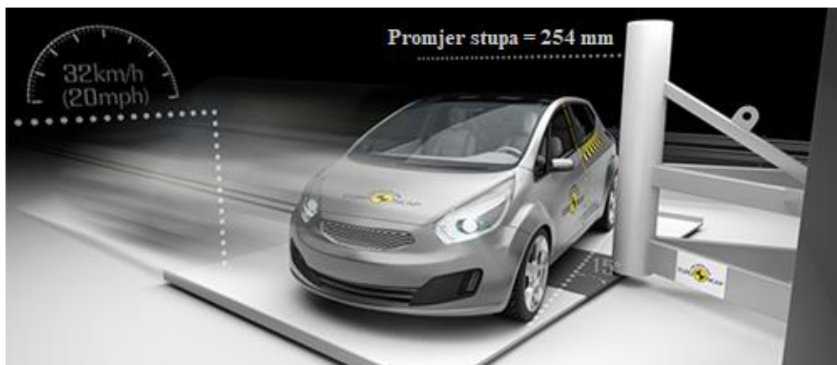
Slika 29: Bočni sudar u čvrsti stup
