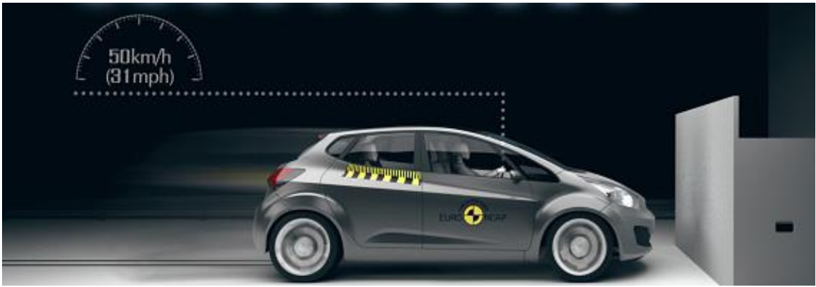
Slika 26: Frontalni sudar cijelom čeonom površinom
