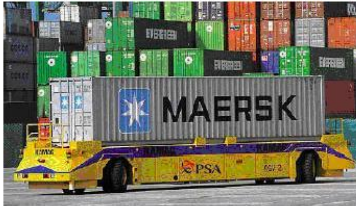
Slika 11. Automatski vođeno vozilo za transport kontejnera
