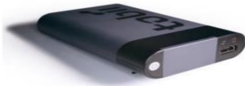
Slika 8. Glavni uređaj za snimanje i pohranu podatak Tobii Pro Glasses 2
