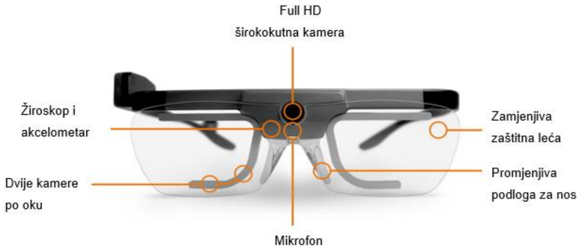
Slika 7. Naočale za praćenje pogleda Tobii Pro Glasses 2
